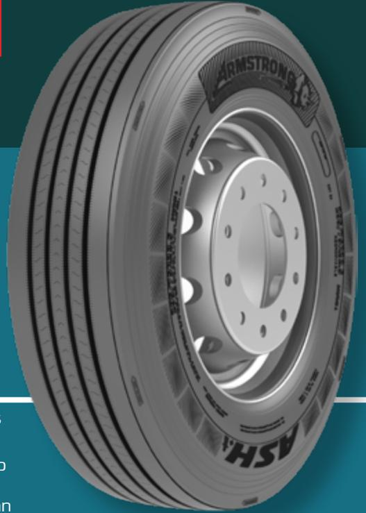
**Un neumático de eje de dirección premium para aplicaciones de larga distancia** con un diseño direccional de la banda de rodadura para un excelente agarre en el camino y tracción en mojado, y un ranurado para garantizar una dirección precisa y reducir el ruido. Los surcos de desacoplamiento y las costillas más anchas de los hombros también ayudan a minimizar el desgaste irregular.
