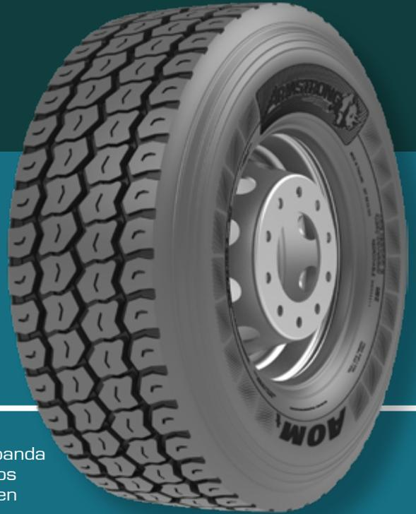
**Un neumático toda posición de base ancha para aplicaciones de servicio mixto** con un diseño robusto de la banda de rodadura para mejorar la flotación y la tracción en suelos blandos y lodo, un compuesto contra cortes y astillas que resiste el abuso en todoterreno, surcos circunferenciales más anchos para mejorar la tracción en mojado y tacos grandes para ayudar a soportar sobrecargas.
