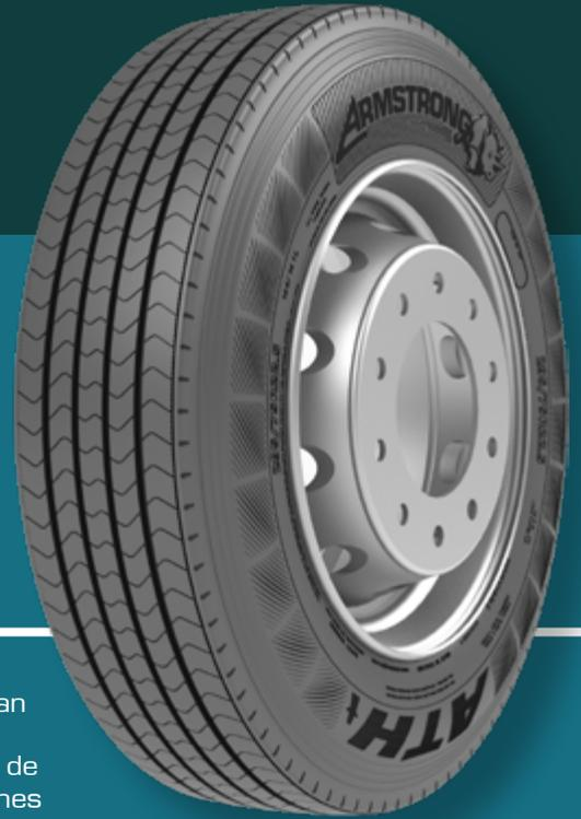
**Un neumático de remolque premium para aplicaciones de larga distancia** con surcos de hombro de diseño exclusivo que brindan resistencia al desgaste desigual en los hombros, una banda de rodadura poco profunda para reducir la resistencia a la rodadura y la acumulación de calor, y surcos circunferenciales para un manejo excepcional en condiciones húmedas.
