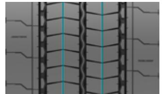
**Tacos anchos regeneradores de la banda de rodadura** con ranuras ocultas que aparecen a medida que se desgasta la banda de rodadura para ofrecer una mejor tracción y seguridad.
