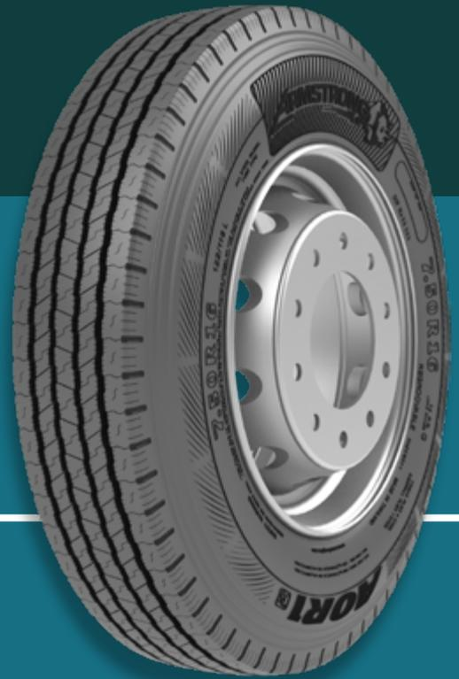
**Un neumático toda posición para aplicaciones regionales y de larga distancia limitada** con un diseño optimizado más ancho de la banda de rodadura para brindar un mayor kilometraje, un área de contacto mejorada para reducir la tasa de desgaste, banda de rodadura poco profunda para reducir la resistencia a la rodadura y resistir la acumulación de calor, y costillas de hombros sólidas para resistir la fricción de las maniobras.
