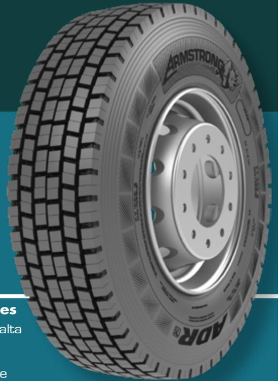
**Un neumático de eje de tracción diseñado para aplicaciones de servicio regional** con la capacidad de soportar condiciones de alta carga, excelente tracción en condiciones húmedas, banda de rodadura original más profunda y más ancha para una vida útil más larga del neumático, y forma de bloques optimizada y diseño único de la banda de rodadura para evitar el desgaste irregular y la retención de piedras.
