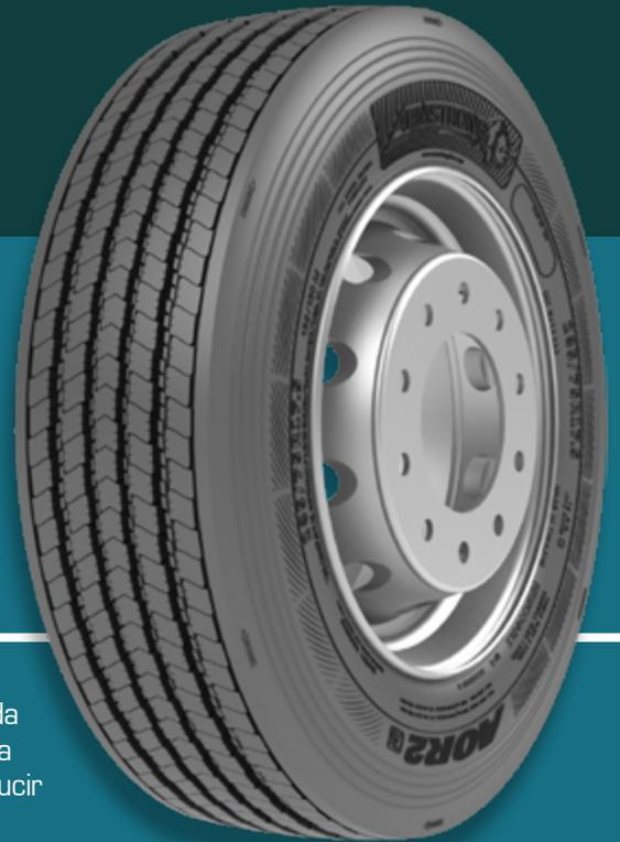
**Un neumático toda posición para aplicaciones regionales y de larga distancia limitada** con un diseño optimizado más ancho de la banda de rodadura para brindar un mayor kilometraje, un área de contacto mejorada para reducir la tasa de desgaste, banda de rodadura poco profunda para reducir la resistencia a la rodadura y resistir la acumulación de calor, y costillas de hombros sólidas para resistir la fricción de las maniobras.
