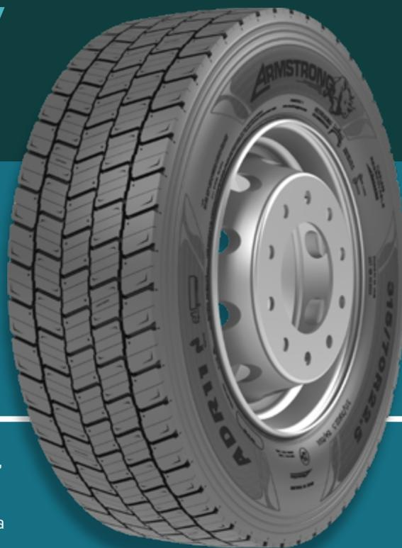
**Un modelo de conducción para aplicaciones regionales** con un diseño único de banda de rodadura direccional para brindar mejor tracción, tacos de banda de rodadura rígidos y compactos para reducir el ruido, un diseño de banda de rodadura más profundo para mejorar el kilometraje y reducir los costos operativos, y laminillas 3D y agujeros profundos para una evacuación de agua más rápida.
