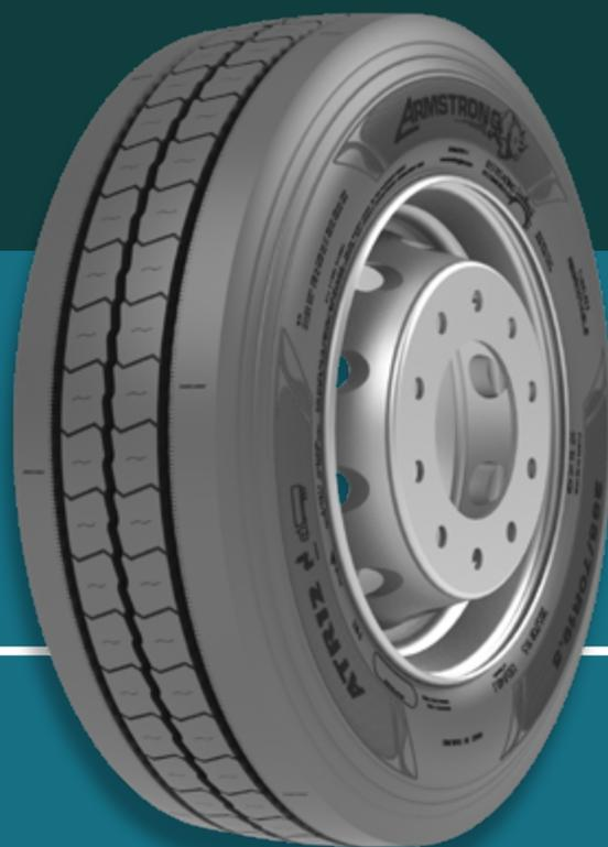
**Neumático de remolque de nueva generación para aplicaciones regionales** diseñado con una banda de rodadura ancha para reducir el desgaste irregular, un compuesto de la banda de rodadura para ofrecer una mejor eficiencia de combustible, nervaduras de relieve sólido que mejoran el frenado en mojado e innovadoras ranuras circunferenciales para una evacuación de agua más rápida.
